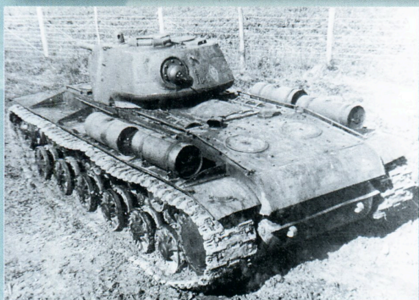
★ Танк КВ-1С выпуска конца 1942 года на полигоне в Кубинке. Лето 1943 года. Хорошо видна форма литой башни и измененная корма корпуса.
