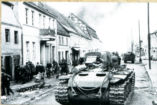
★ Танковый тягач KB-T на базе KB-1C на улице немецкого города. Германия, апрель 1945 года.
